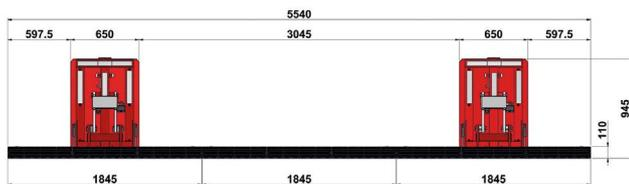
Sperrung mit drei Elementen: zwei geschlossen, ein abgesenkt. Durchfahrtsbreite: 3 Meter.
