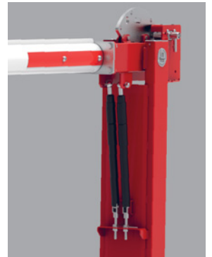
Zwei Gasdruckfedern (ab 6,0 m) mit je zwei Kolben ergeben das von uns entwickelte „ Doppel-Hub-Gasdruckfeder-System “ als Gegengewichtsausgleich zur einfachen Handhabung.
