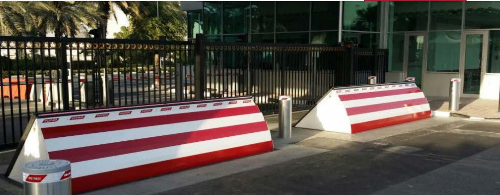
**ARMIS RB1000** wurden für die Flachmontage konzipiert und benötigen eine Fundamenttiefe von nur 400mm. Dies erlaubt eine einfache und kostengünstige Montage, unabhängig von bestehenden Einrichtungen wie Kabelkanälen, Entwässerungssystemen usw. Ebenso ist eine ebenerdige Montage in Hanglage möglich.
