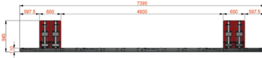
Barrière à quatre éléments : deux fermés et deux abaissés. Largeur de passage: 4,9 mètres
