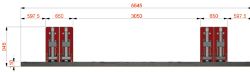
Barrière à trois éléments : deux fermés et un élément abaissé. Largeur de passage: 3,05 mètres
