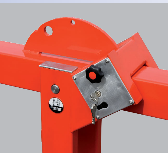
Automatische Endlagen-Verriegelung durch Edelstahl Sperrbolzen. Höchste Sicherheit für den Bediener. Standardlieferung mit einem Profilzylinderschloss.
