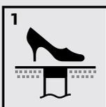
1 Bündige und abgeschlossene Bodenhülse mit geringer Öffnung
