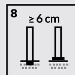
8 Bodenstück für geringe Einbautiefen / Sockelmontage auf Fundament oder Betonboden (projektspezifische Einbaulängen möglich)
