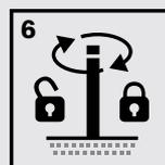
6 Automatische Arretierung beim Eindrehen des Pfostens
