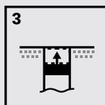
3 Bodenhülse mit integriertem Deckelabschluss für den Einsatz als Ruhehülse
