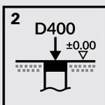
2 Bodenebenes Fundament mit Belastungsklasse D400. Barriere- und stolperfreier Übergang für Passanten und Verkehrsteilnehmer
