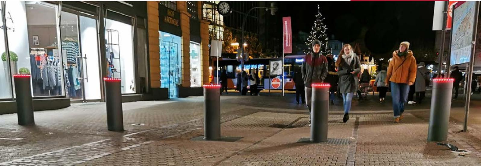
Die **automatischen Hochsicherheitspoller ARMIS 72|50** mit integriertem Hydraulikantrieb schützen zuverlässig vor Fahrzeugangriffen. Sie eignen sich für die Zufahrtsregelung in Innenstädten oder für Hochsicherheitsabsperungen von besonders schützenswerten Einrichtungen wie Forschungszentren, Botschaften, Polizeieinrichtungen, Militärstützpunkte und viele mehr.
